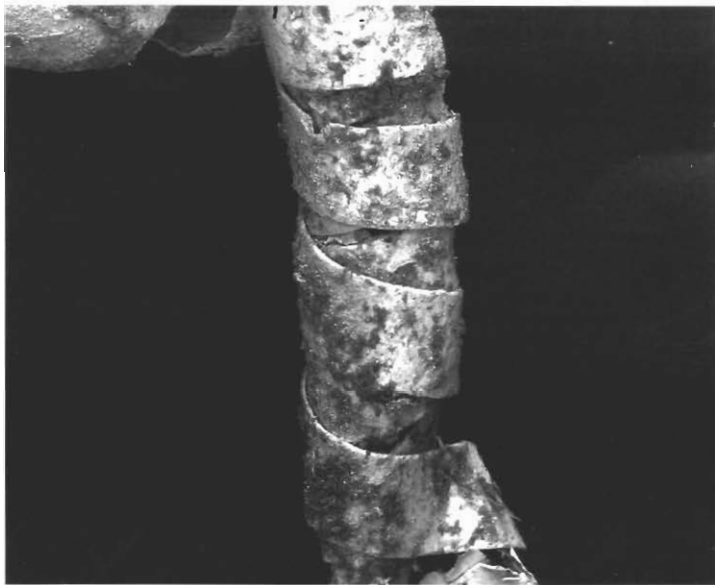
Abb. 7 Silberlahn, in S-Richtung um Seidenseele gewickelt (REM-Aufnahme 1167-1)
