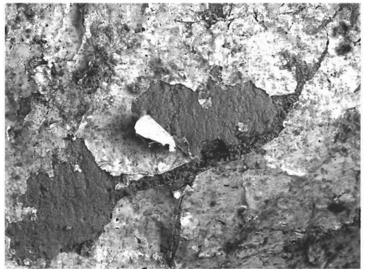
Abb. 4 Häutchengold: Tierische Membran als Trägerschicht mit Metallauflage (REM-Aufnahme 1075-2-3)
